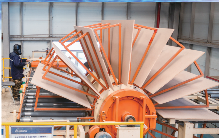
在位于曹妃甸的金隅天坛(唐山)木业科技有限公司,工作人员在自动检板线进行板材二次检验。
