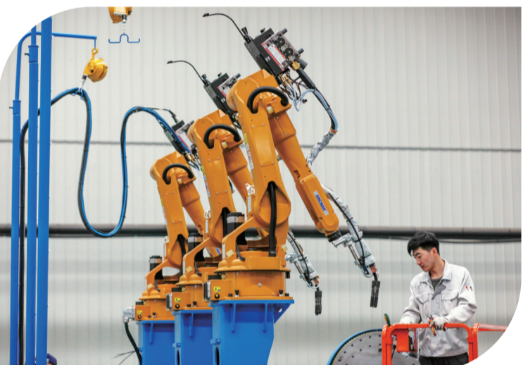
唐山开元自动焊接设备有限公司组装车间工人正在调试焊接生产设备
