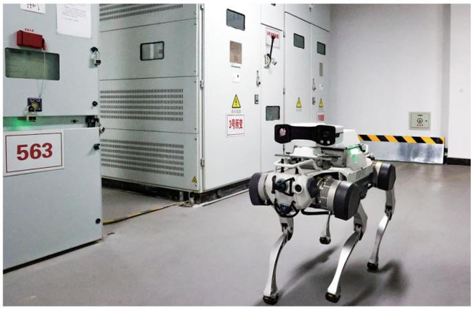
在220千伏君瑞变电站设备间内,国网唐山供电公司正在利用机器人在设备间对设备进行巡检。
