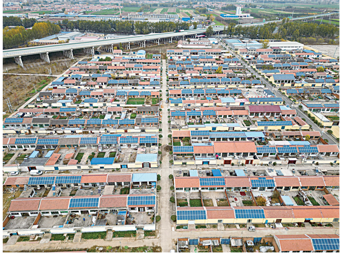
河北省玉田县孤村镇庄户村内的屋顶光伏发电设备(11月12日摄,无人机照片)。 为加快推进农村地区清洁取暖,近年来,河北省玉田县有序推进“光伏+电采暖”工程,安装分布式光伏3.4万余户。进入取暖季后,国网玉田县供电公司的工作人员开始对线路进行巡查检测,检查取暖供电设备,测量暖气温度,确保群众实现清洁温暖过冬。 新华社记者 牟宇 摄
