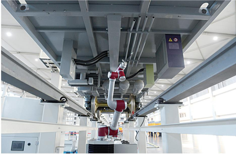
12月5日，百川机器人共享智能制造工厂车底吹扫机器人正在作业。
