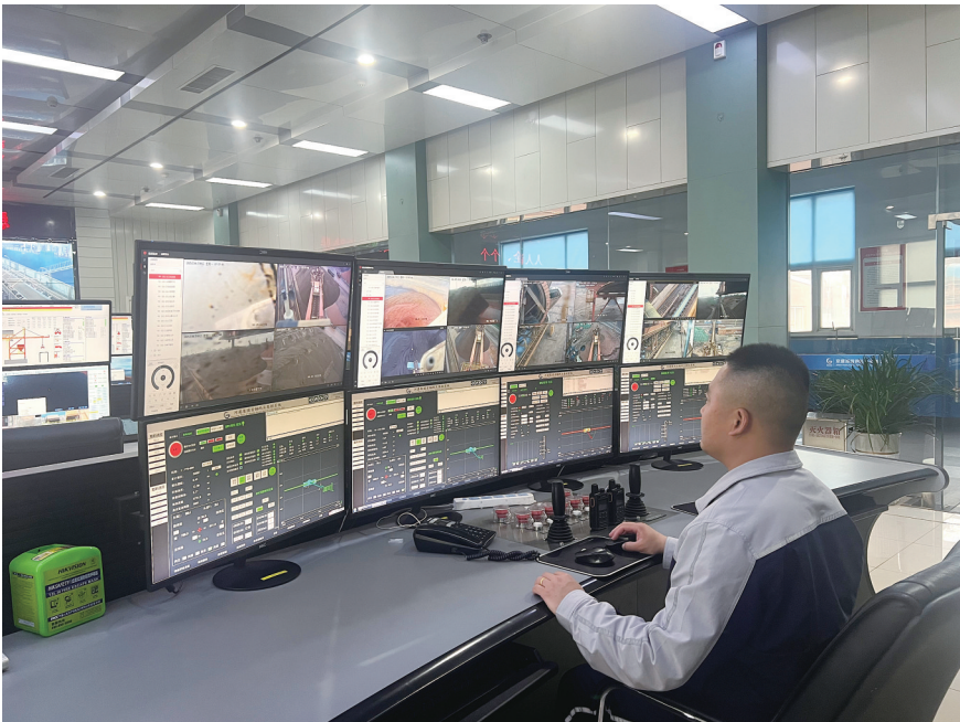
图为斗轮机司机在矿石码头公司中控室远程操控堆取料作业。 薄贺然 摄
