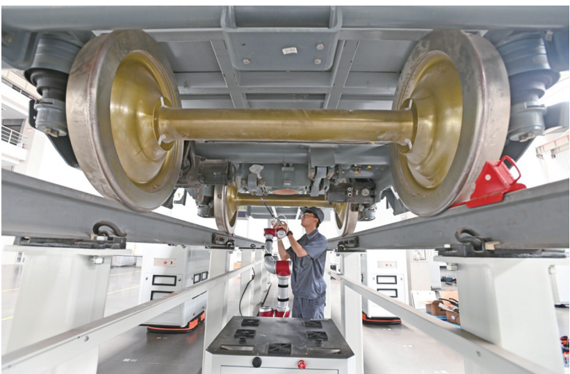
图为技术人员正在调试智能车底吹扫机器人。
