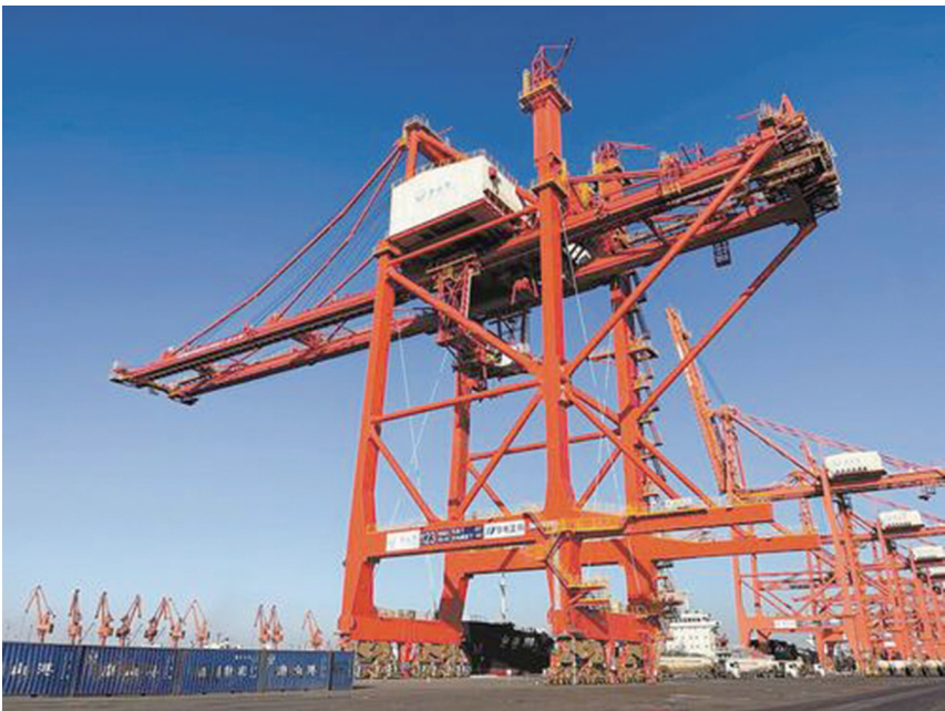
图为6月20日拍摄的新一代跨越式双小车自动化岸桥。 唐港集团供图
