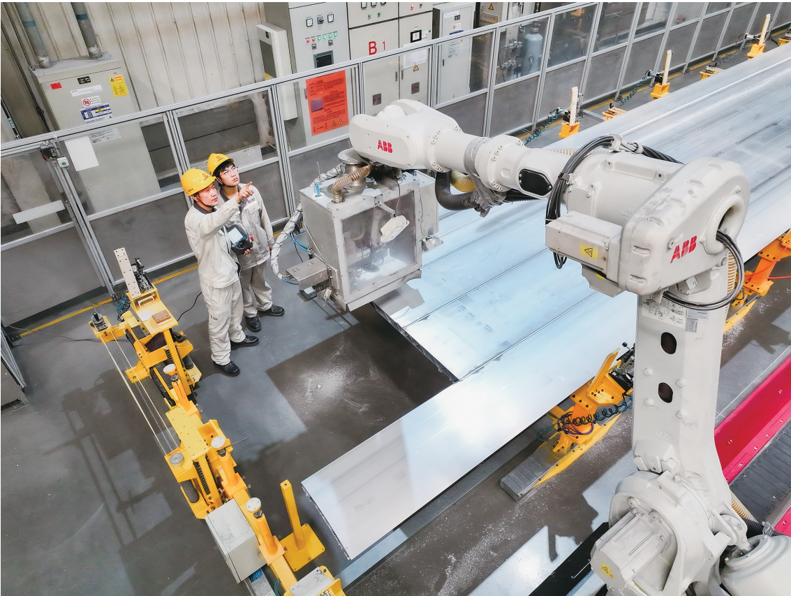
中车唐山公司车体事业部工程师正在查看动车组侧墙智能打磨工序情况。
