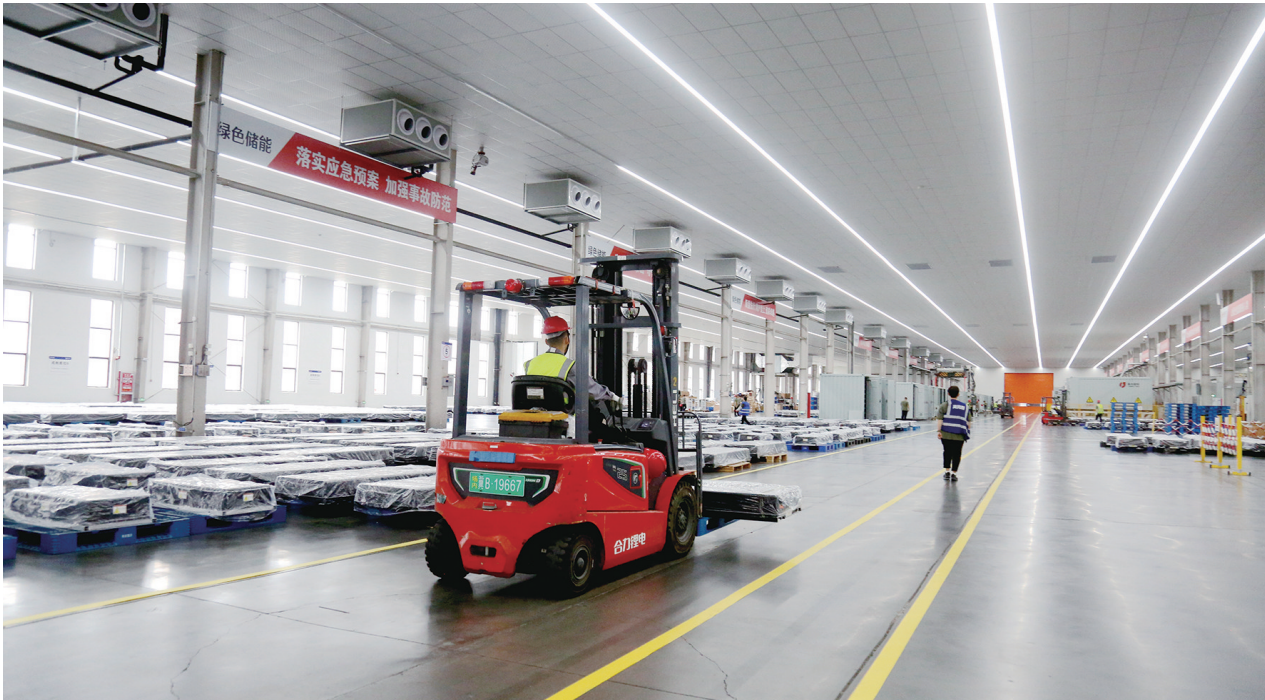
▲图为唐山国轩电池有限公司pack车间成品区，电池包组装完成，由成品班组用叉车转运至成舱区，供集装箱入舱集成。
