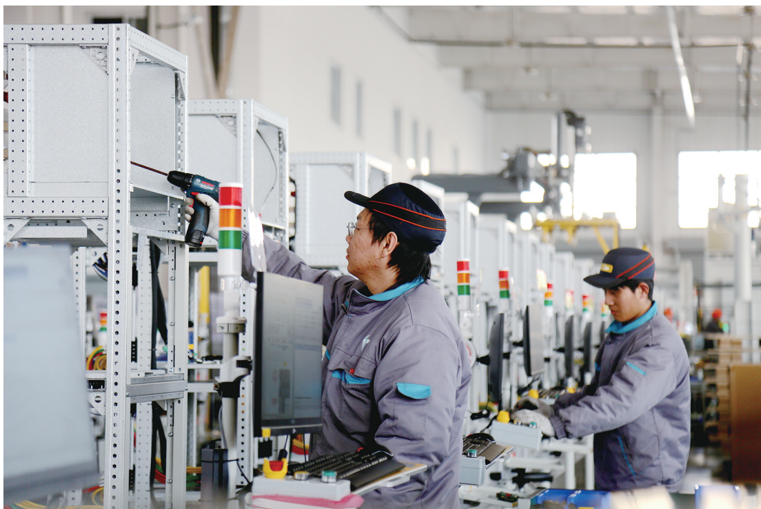
图为唐山能源集团特来电智能充电设备有限公司的工人,正在装配车间进行400kW大功率一体式直流充电机的组装工作。 马雅雄 摄
