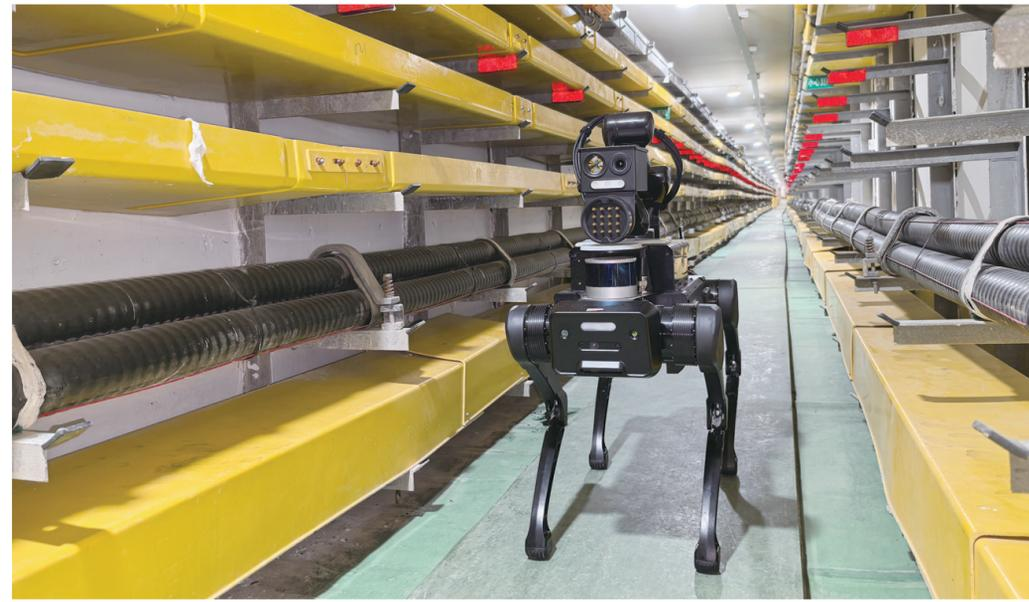
图为搭载智能巡检模块的四足式机器人在110千伏电缆隧道内对电缆设备进行全面扫描。
