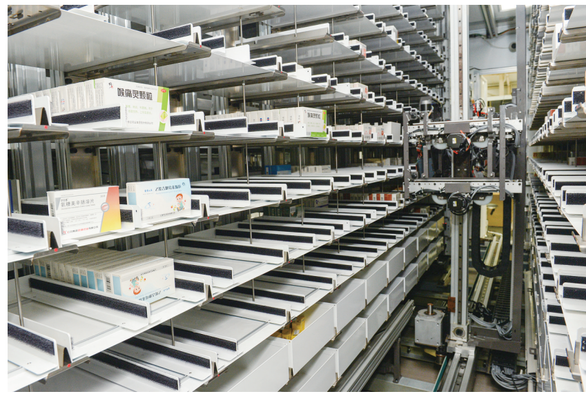
图为晟群科技一体化全药品机器人智慧药房里机器人正在取药。
