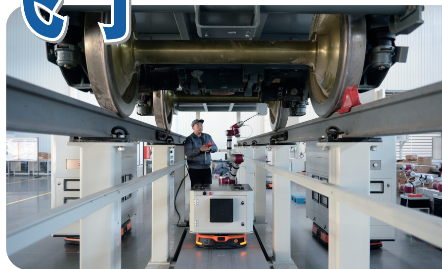
唐山百川机器人共享制造工厂内技术人员正在调试车底吹扫机器人 吕泽宣摄
