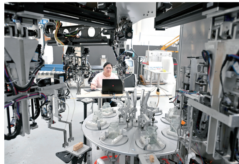
唐山四维智能科技有限公司为北京王致和研发的腐乳自动装瓶机器人。
