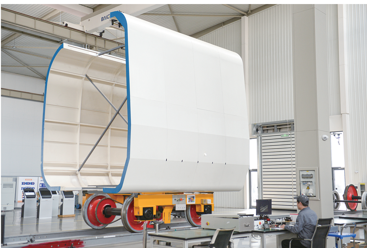
图为工程师正在调试车轮多边形在线检测系统。
