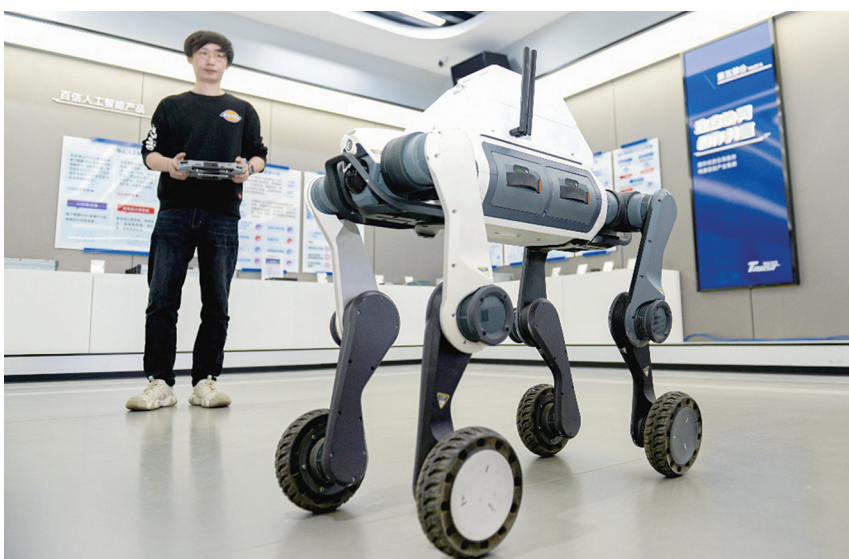
图为展厅内四足机器人正在工程师的遥控下模拟避障。
