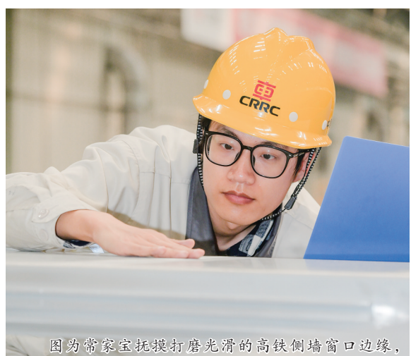
图为常家宝托摸打磨光滑的高铁侧墙窗口边缘,检查机器人打磨质量。 云钊 摄
