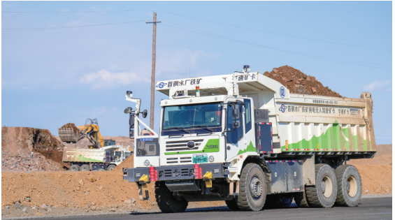
▲图为4月28日,无人驾驶矿用卡车正在首钢矿业水厂铁矿无人驾驶采场运送货物。
