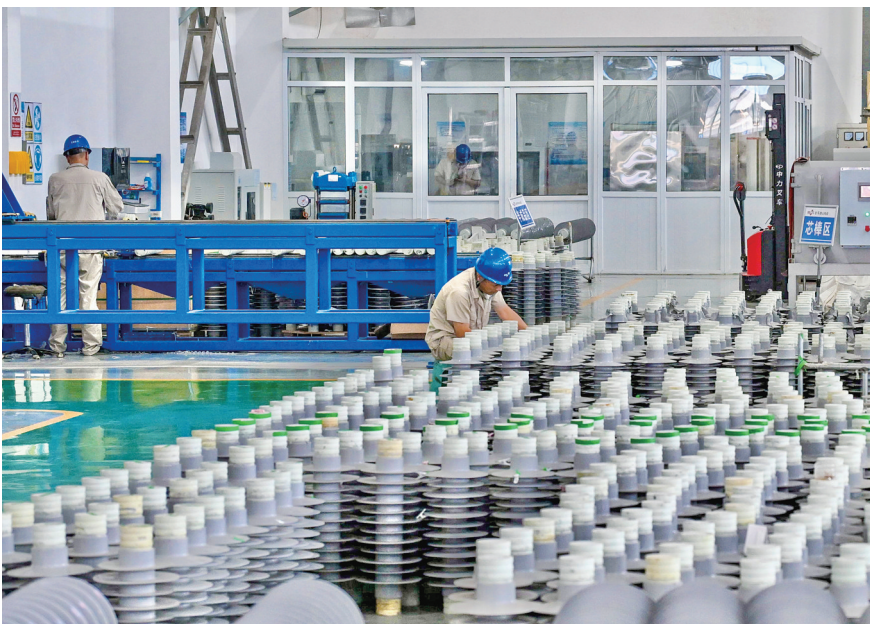
图为工作人员正在对注射成型好的复合支柱绝缘子进行外观检查和边缘修整。本报记者 徐慧 摄
