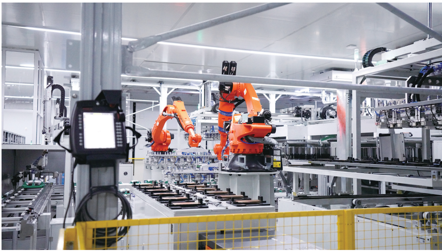
图为唐山国轩电池有限公司雅马哈机器人从物流线上自动夹取卷芯上下料。马雅雄 摄
